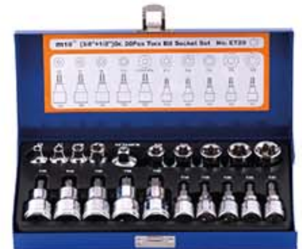
บ็อกซ์ชุดขนาด 3 หุน, 4 หุน (20 ชิ้น) รหัส : 003-036-620 รุ่น : ET20 (3/8" E-Socket : E6, E7, E8, E10) (1/2" E-Socket : E12, E14, E16, E18, E20) (3/8" T-Socket : T10, T15, T20, T25, T27) (1/2" T-Socket : T30, T40, T45, T50, T55)
