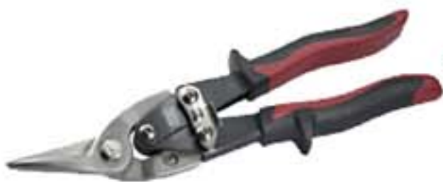
นรสรตัดสังกะสี 10 นิ้ว รุ่น A1003R ผลิตจากเหล็กโครเมี่ยมวานาเดียม ด้ามจับพลาสติกโค้งกว้าง สำหรับตัดที่สมบูรณ์แบบ
